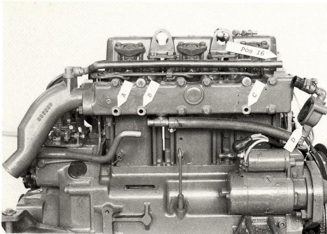
1. Demontera bultarna A, B och C på avgaslimpans nedre bultrad. Demontera termostathuset D. Byt termostaten och temperaturgivaren (pos. 16) mot de ur satsen.
