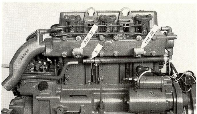
4. Lossa sjövattenpumpens slang (rör) vid T-stycket E under avgaslimpan. Vid rörmontage böj ut röret ca 3–5 cm från T-stycket. Montera MS 101 (pos. 28) fästena med bult M8×100 mm, med skålarna uppåt i bulthål A och C. Drag ej åt bultarna för hårt.
