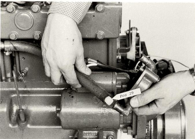
2. Innan termostaten återmonteras, stoppa in plastpluggen (pos. 29) i slangens undera del vid termostathuset. Återmontera termostathuset.
