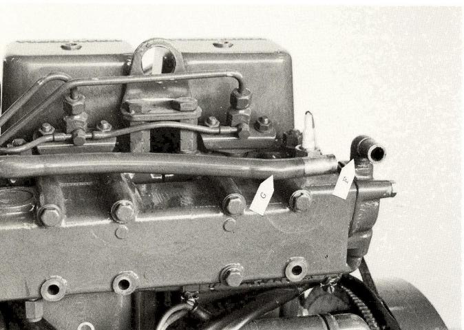
3. F. Vrid termostathusets övre 90° slanganslutning 90° mot SB. Böj ut och ner vattenröret G på avgaskröken så att röret går emot den främre översta bultskallen på avgaslimpan
