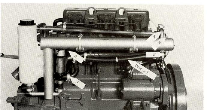
6. Återmontera bult B på avgaslimpan med motorns elhärv och elpumps bruna jordkabel (–).
