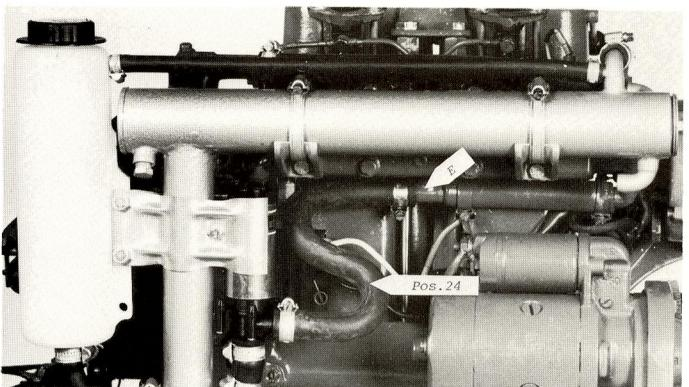
5. Träd på de monterade slangarna på termostathuset och avgaskröken och lägg värmeväxlaren i MS 101 fästen. Öppna slangklammorna SMS 56 (pos. 27), träd i slangklammorna i skårorna på MS 101-fästena och slut den kring värmeväxlaren. Skruva några varv för hand på klamman så den "gång" innan mejsel används. Fixera värmeväxlaren i lod. Efterdrag M8 bultarna till MS 101-fästena samt slangklammorna. Montera den formgjutna slangen (pos. 24) mellan elcirkulationspumpen och T-stycket E under avgaslimpan.
