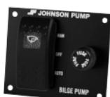
commande pour l'interrupteur AS888 vous aurez une installation parfaite pour votre bateau. Le tableau comprend un interrupteur à 3 positions: Arrêt, Marche mode manuel, Marche mode automatique - qui fonctionne en association avec le AS888. Support fusible intégré et un indicateur lumineux. Fusibles inclus. L'interrupteur est noir mat. Taille: 76 x 55 mm, profondeur: 40 mm.
