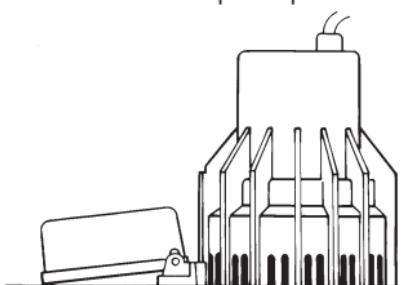
Der Schalter AS888 soll immer parallel zum Bilgengrund, mit dem Schwimmkörper direkt nach hinten weisend, angebracht werden. Den Schalter niemals niedriger als auf der Einlaßhöhe der Bilgenpumpe einbauen.
