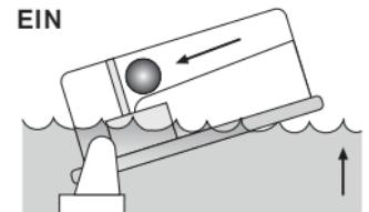
Das Wasser hebt den Schalter, die Kugel rollt zurück, Schalter schaltet ein.
