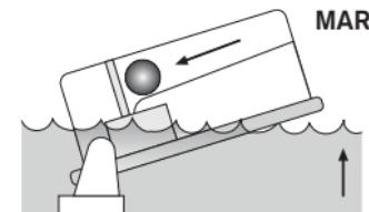
L'eau soulève l'interrupteur, la bille roule vers l'arrière, l'interrupteur commute en mode marche.
