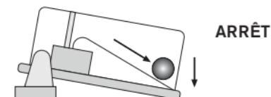
La bille est au repos, l'interrupteur est en mode arrêt.
