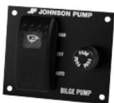
l'interruttore AS888 garantisce una eccellente installazione per la vostra barca. Il pannello ha un interruttore a 3 posizioni per Spento, Acceso, manuale ed Acceso automatico. In "Acceso automatico" il funzionamento è gestito dall'interruttore AS888. Portafusibile integrato completo di luce di spia. Fusibile incluso.
