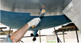
Applicera Hempel's High Protect II med rulle
