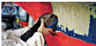
Borttagning av gelcoat
