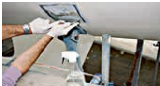
Våtskrapa för att ta bort gammal bottenfärg
