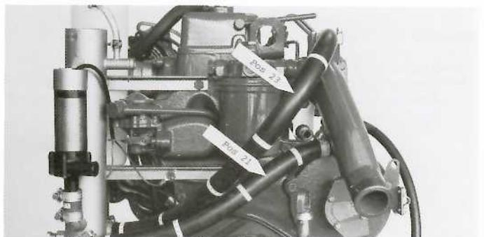
6. Montera slang  $1/2'' \times 360$  mm (pos. 21) mellan sjövattenpumpens avkapade rör och värmeväxlarens undre aktra slanganslutning. OBS! Slangen får ej ligga mot avgaskrökens undre okylda del. Mellan värmeväxlarens främre undre anslutning monteras slang  $5/8'' \times 580$  mm (pos. 23) till avgaskrökens vända utsläpp.
